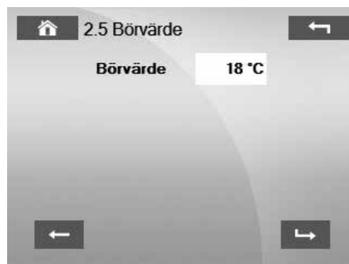
Här ställer du in önskad tilluftstemperatur (börvärde). Notera att detta värde inte ska förväxlas med önskad inomhustemperatur. Detta sköter husets värmesystem om. Rekommenderat börvärde är 16 - 19° C, fabriksinställning är 18° C.
